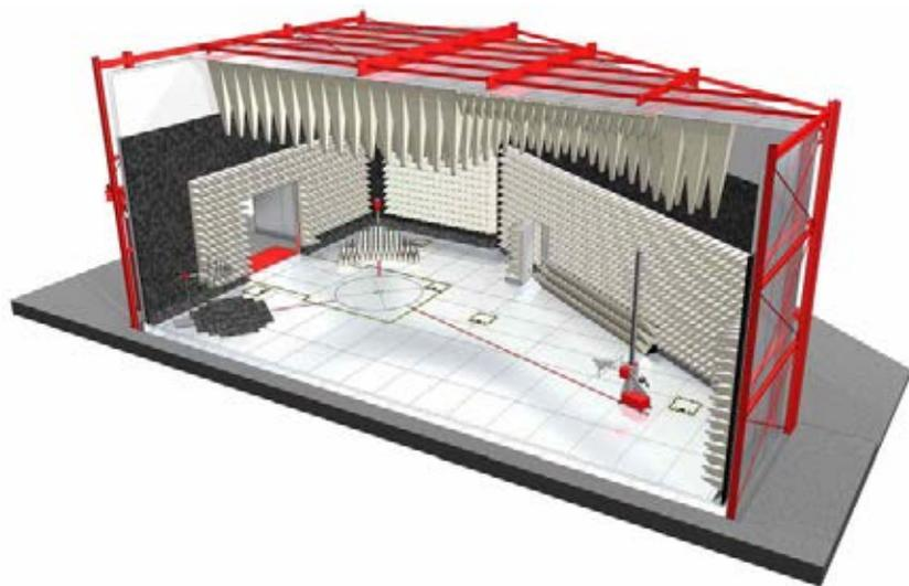
SAC-10 Plus Triton - это готовое решение Frankonia, представляющее собой полубезэховую камеру для испытаний на ЭМС с несколькими испытательными осями, обеспечивающую измерительные расстояния 10 м, 5 м и 3 м и тихую зону (QZ)  $\varnothing 3,0$  м.
