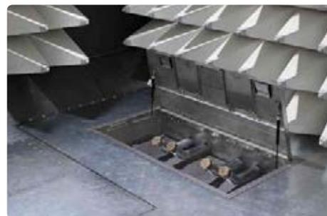
Проходная панель с трубопроводом для жидкостей и газов для охлаждения ИТС
