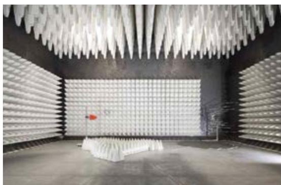
Испытательная ось 2 - испытания на эмиссию/устойчивость
