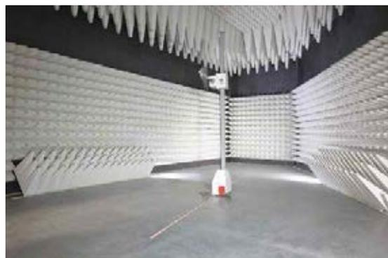
Испытательная ось 1 - испытания на эмиссию
