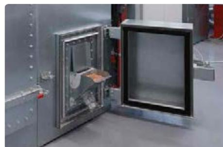
Радиочастотный фильтр на проходной панели для специальных кабелей
