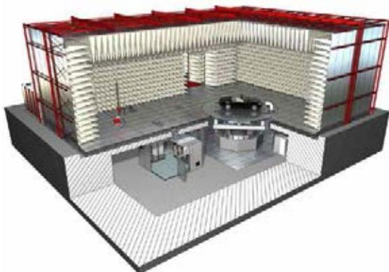
Камеры SAC-10 представляют собой настраиваемые готовые решения для испытаний на ЭМС, полностью соответствующие требованиям стандартов, обеспечивающие измерительное расстояние 10,0 м, предлагающие различные размеры тихой зоны (QZ). Размеры этой полуэховой камеры варьируются и имеется несколько вариантов конфигурации. Инновационная концепция с внушительной отделкой поглотителем обеспечивает исключительные характеристики для проведения испытаний на эмиссию и устойчивость.
